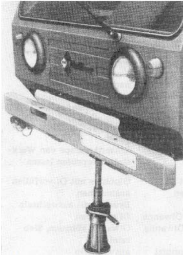
Bild 62. Unterstellen des Wagenhebers, vorn
